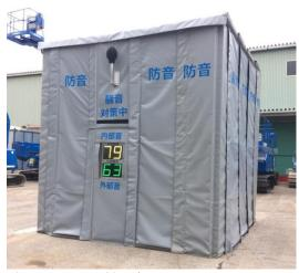
吸遮音パネルに表示部やマイクの取付け部を埋め込んでいるため、騒音表示パネル自体にノイズ ソーバー同様の防音効果があります。表示部本体とフレームをアルミで製作し、重くなりがちな表 示付きパネルを 13.4kg という軽さに抑えました。
