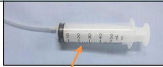
上記3点を確認しても出ない場合は、ポンプスイッチを“OFF”にした状態で、ドリル側逆止弁付継手から給水ホースを外して注射器を差込み、水を吸い上げてください。
