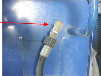
5. 切替スイッチを「手動」にしてホースジョイント部から水が出なくなるまで空運転させてください。
