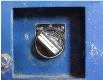
6. 切替スイッチを「切」にしてください。これで水抜き作業は完了です。
