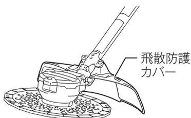
12. ナイロンコードカッタを使用できる製品は、ナイロンコードカッタ専用の飛散防護カバーを使用してください。飛散防護カバーを取り付けるときは、ナイロンコード用のカッタに触れないでください。
