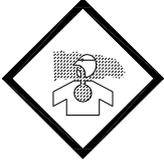
排気ガス中毒防止の為、室内、トンネル内、船倉、タンク内、テント等換気の悪い所では使用しないでください。また、建物や遮断物で風通しの悪い場所では使用しないでください。
