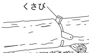
ソーチェーンが木材にはさまりチェーンソーが抜けなくなった場合は、直ちにエンジンを停止して切り口にくさびを押し込んで開き、チェーンソーを引き出してください。
