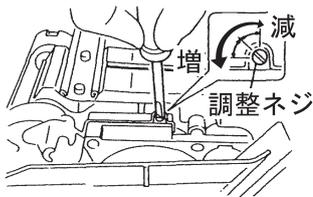
チェーンオイルの吐出量は、本体下部の調整ネジにより調整できます。必要に応じて調整ネジをマイナスドライバーで回し、吐出量を調整してください。
