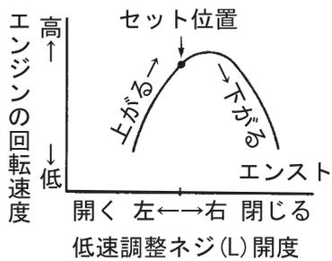
3. 低速調整ネジ（L）は以下の手順を参考に調整してください。
