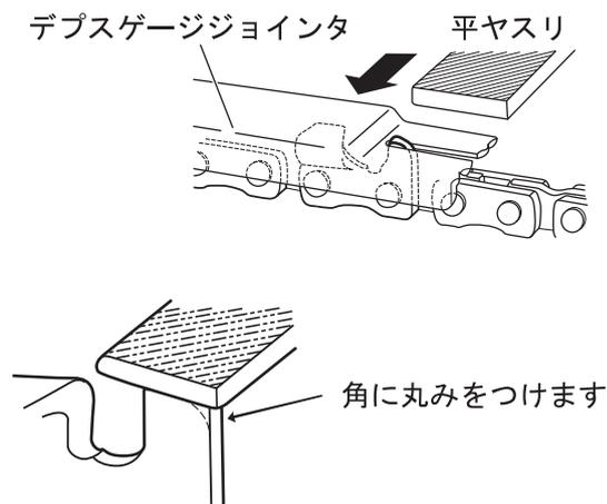
5. デプスゲージの調整は、デプスゲージジョインタと平ヤスリを用いてください。デプスゲージジョインタと平ヤスリは別売りです。
