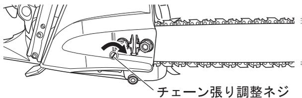
6. スプロケットカバー取り付け用のナット（2個）を軽く締めてください。（チェーン張り金具が外れずガイドバーが動く程度）
