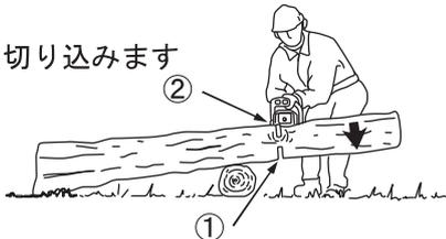
木材が一端のみで支えられている場合は、最初の切り込み①は木材の直径の約 1/3 まで上方向に行います。第二の切り込み②は下方向に行い、最初の切り込みにつながるようにします。
