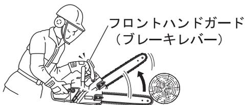
チェーンブレーキは、フロントハンドガード（ブレーキレバー）が前方に押されることにより作動します。手前に引くことにより解除されます。
