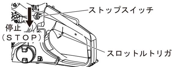
スロットルトリガから指を離し、ストップスイッチを停止 (STOP) 位置にしてください。
