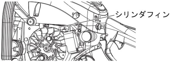
シリンダフィンにゴミが詰まるとエンジンの冷却効果が悪くなります。シリンダフィンの間のゴミやホコリを取り除いて冷却風の通りを良くしてください。
