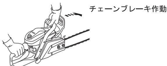
2. フロントハンドガード（ブレーキレバー）を前方に押し、チェーンブレーキを作動させてください。
