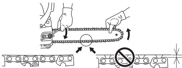
1. ガイドバーの先端を持ち上げ、チェーン張り調整ネジを矢印の方向に回し、ソーチェーンがバー下側に接触する程度に調整してください。スプロケットノーズガイドバー使用の時は、ソーチェーンがバー下側に接触する程度に調整後、チェーン張り調整ネジをさらにハードノーズバーよりやや強めに張る方向に調整してください。
