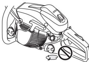
燃料を補給した後、燃料タンクキャップを確実に締め付け、燃料パイプ、燃料系グロメット、燃料タンクキャップ周辺から燃料の漏れ、にじみがないことを確認してください。
