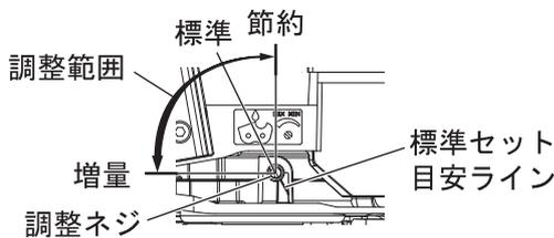
調整ネジの頭の溝を必要に応じて図の位置にあわせてください。
