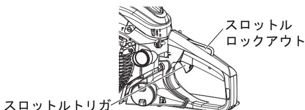
7. 始動後はすぐにスロットルロックアウト（スロットルトリガの誤操作を防ぐ安全装置）を押しながらスロットルトリガを少しだけ引いて、ラッチ状態を解除してください。
